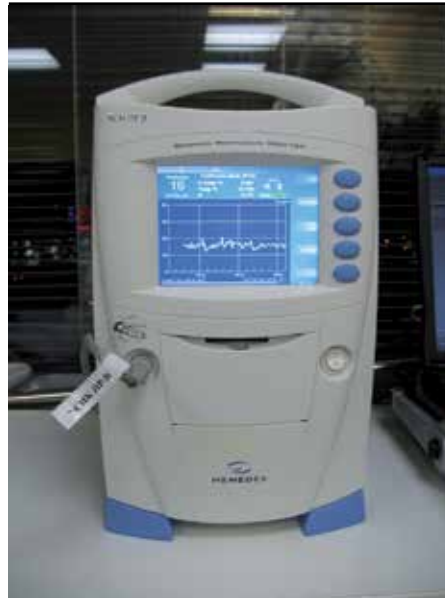
Obrázek 4. Přístroj pro přímé měření CBF v absolutních hodnotách (Hemedex)
