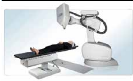
Obrázok 6. Systém CyberKnife, ktorý pozostáva z dvojice robotických ramien – jedno nesie lineárny urýchľovač, druhé liečebný stôl s pacientom. Zdroj: Accuray
