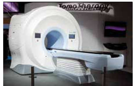
Obrázok 7. Ožarovací prístroj TomoTherapy využíva usporiadanie podobné CT prístroju, kde röntgenová lampa je nahradená malým rotujúcim lineárnym urýchľovačom s energiou 4MV. Zdroj: Accuray
